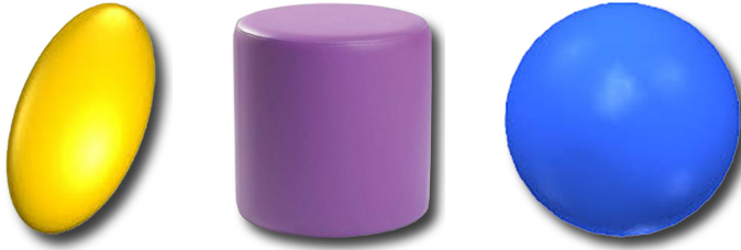
FIGURE 12.9 Ellipsoïde (trois moments d'inertie différents), cylindre (deux moments d'inertie différents) et sphère (trois moments d'inertie égaux).
